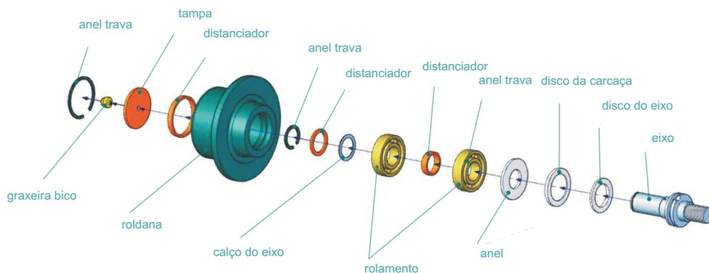
Devido a ação da carga que ocorre nos rolamentos internos e no corpo de apoio, é gerado a componente de direção axial.
